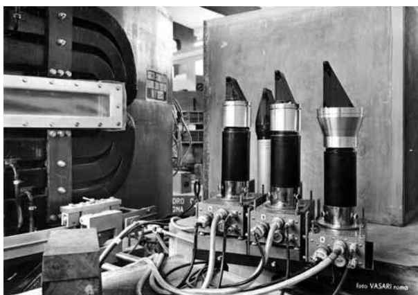
Fig. 2 Spettrometro a coppie (1959)
