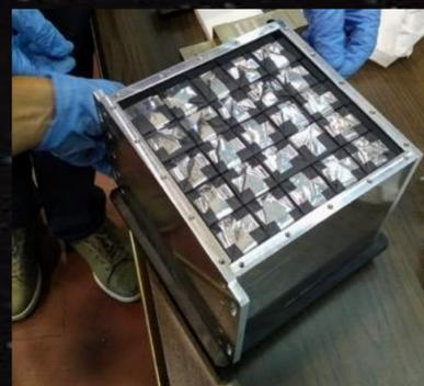
La parte centrale del calorimetro elettromagnetico
