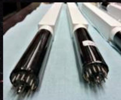
Cristalli scintillanti e fotosensori del calorimetro
