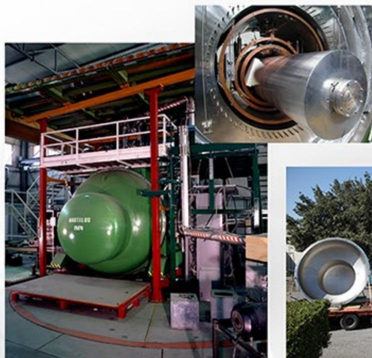
L'antenna gravitazionale Nautilus, in alto un particolare della barra cilindrica. A destra il rivelatore durante il trasporto
