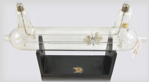
All'interno di un tubo a vuoto si trova posto un mulinello a pale libero di muoversi lungo due rotaie. Applicando una differenza di potenziale agli elettrodi si notava che il mulinello cominciava a girare quando colpito dalla radiazione catodica.
