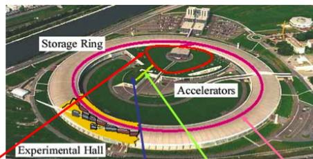
Booster - piccolo anello che prepara il fascio del linac per una migliore efficienza di iniezione
