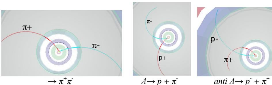
Vediamo che per uno stato finale pione-pione la configurazione di decadimento è quasi simmetrica, mentre invece per lo stato finale pione-protone il raggio di curvatura del protone è più grande di quello del pione: infatti a causa della sua massa più grande il protone trasporta la maggior parte della quantità di moto iniziale.
