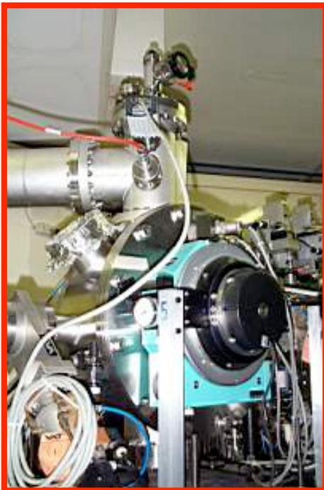
Elemento fondamentale della linea e' il **monocromatore**, cioe' un sistema che permette la selezione delle energie per il particolare esperimento progettato
