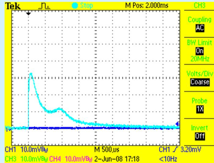
$R_u=1\text{ M}\Omega$ , 500  $\mu\text{s}$ /div
