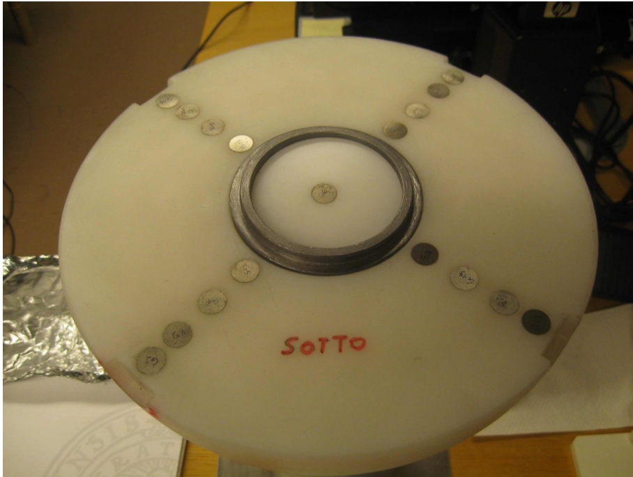
Semisfera inferiore con calotta in Pb e lamine di Dy inserite
