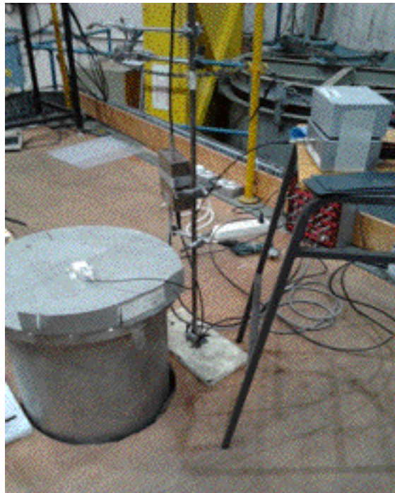
Figura 17. “Thermal pile” del NPL. Bocca di uscita della colonna termica.
